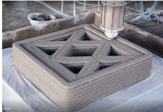
Fig. 35 – 3D-printen van beton
