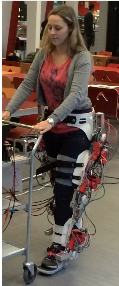
Assistief exoskeleton Mirad helpt mensen met spierzwakte om autonoom te stappen. © VUB en KU Leuven
